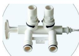
Gli addolcitori BravoCAB sono dotati di by-pass con taratore di durezza incorporato. Esso è realizzato completamente in plastica alimentare e si monta con il solo ausilio di clips. Nessuna parte a contatto con l'acqua addolcita è realizzata in metallo eliminando il rischio di corrosioni con conseguente rilascio di metalli nell'acqua.
